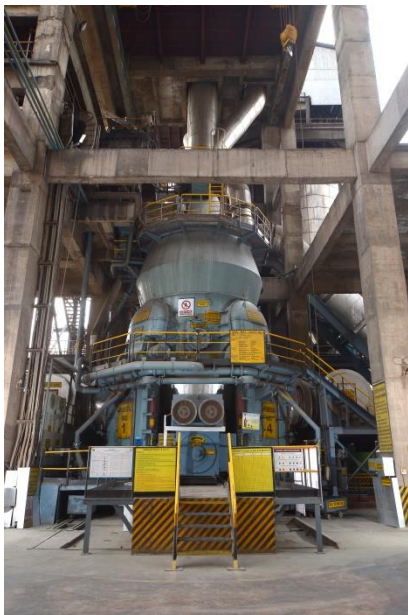
在印度 Kotputli 相似的 LOESCHE 磨型 LM 43.4 D
