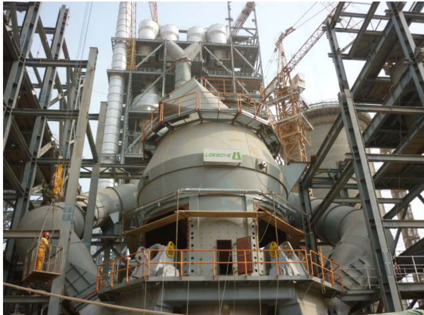
在沙特阿拉伯塔哈马的型号为 LM 56.4 的莱歇磨
