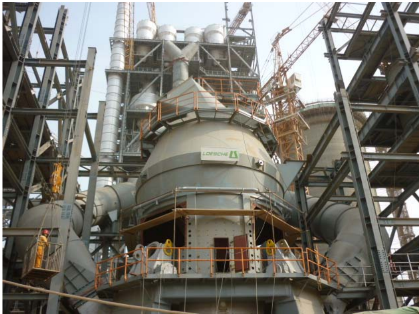
Un molino LOESCHE del tipo LM 56.4 en Tahamah, Arabia Saudita
