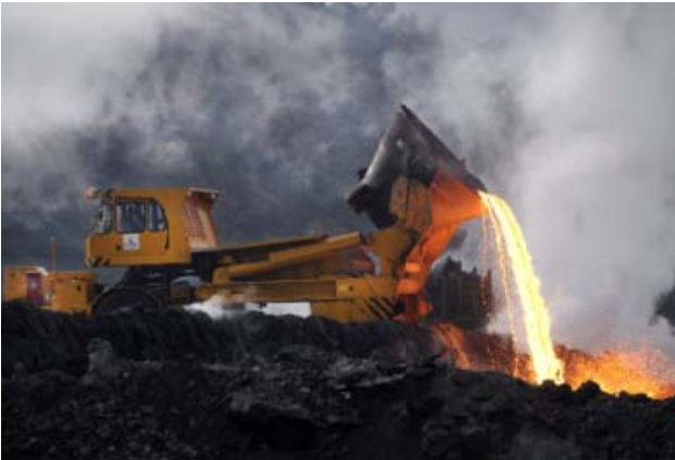
Литье из шлама металлургического цеха на шлаке
