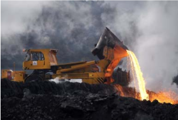
Steelworks slag casting on the slag bed
