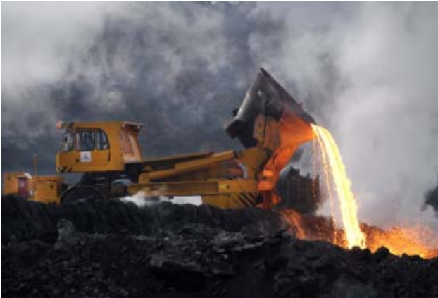
Stahlwerksschlackenabguss auf das Schlackebeet
