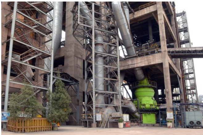
Станок типа LOESCHE LM 26.3 D для измельчения лигнита, Наллалингейпалли, Индия
