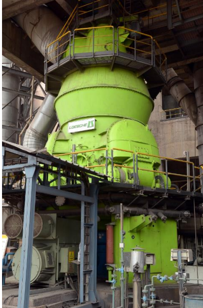
Станок типа LOESCHE LM 26.3 D для измельчения lignита, Налпалингейпалли, Индия
