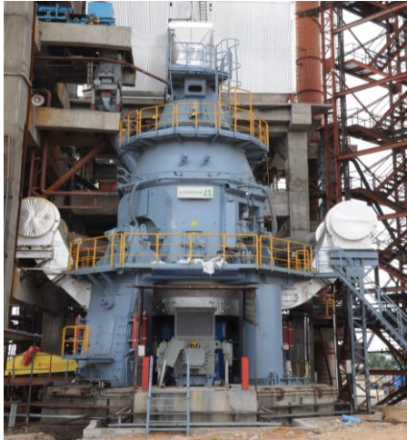
Мельница LOESCHE типа LM 35.2+2 CS на предприятии Sri Balaha Chemicals Pvt. Ltd, г. Хиндупер
