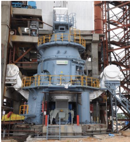
El molino LOESCHE tipo LM 35.2+2 CS en Sri Balaha Chemicals Pvt. Ltd, Hindupur (India)
