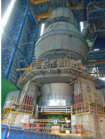
*Die LOESCHE Mühle Typ LM 70.4+4 CS mit dem neuen COPE-Getriebe in Betrieb im Zementwerk Mfamosing*
