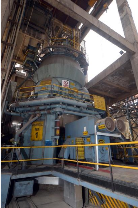
在印度科特普特利 i 的用于粉磨石油焦的莱歇磨 LM 43.4 D
