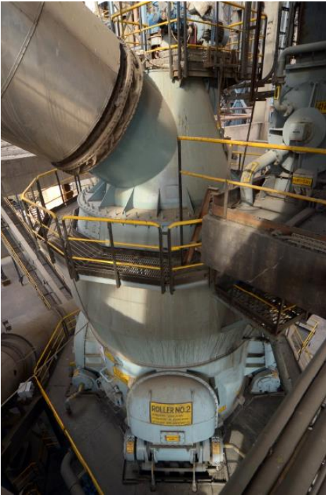
Vista del rodillo n.º 2 del molino Loesche del tipo LM 43.4 D
