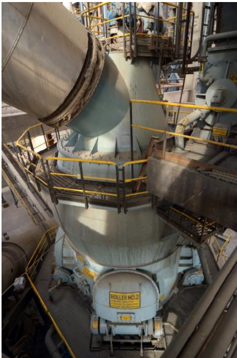
Ansicht von Walze No 2 der Loesche-Mühle des Typs LM 43.4 D
