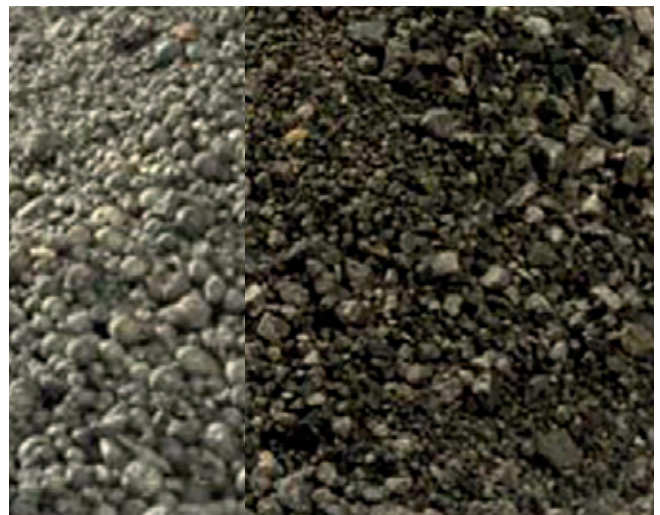
Тяжелый продукт (металл) и легкий продукт (наполнитель) после сухой сортировки по плотности (< 2 мм)
